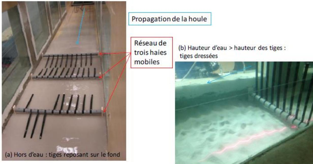
Figure 2-4 : Haies mobiles dans le canal à houle
