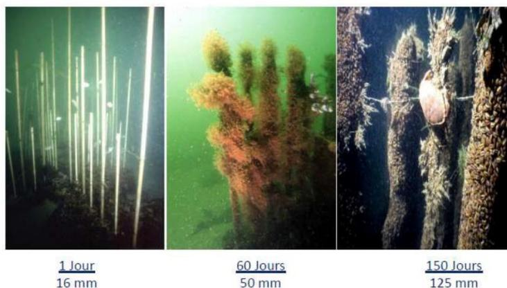
Figure 24 Photo de l'expérience du Cap Ferret (Source : Biobamb)
